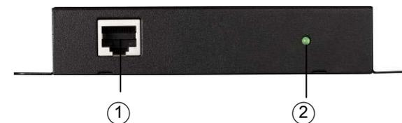
1. RJ-45 для подключения кабеля CAT5
