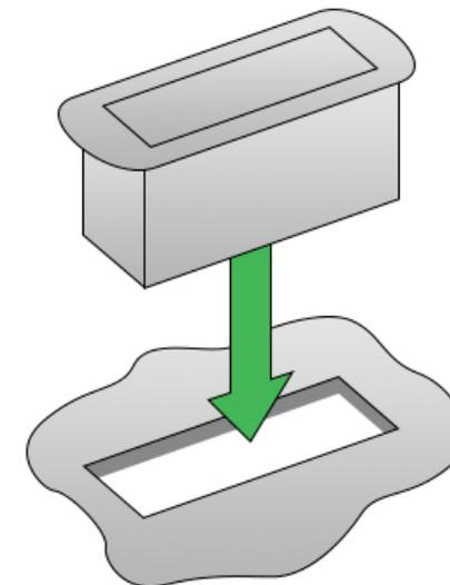
3. Закрутите два крепежных винта, зафиксированные в углах корпуса гайки. Закручиваясь, винты упрутся в тыльную сторону поверхности и зафиксируют корпус.
