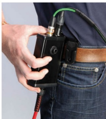
кабель-адаптер с замком-фиксатором на ремне; возможность поворота и отсоединения
