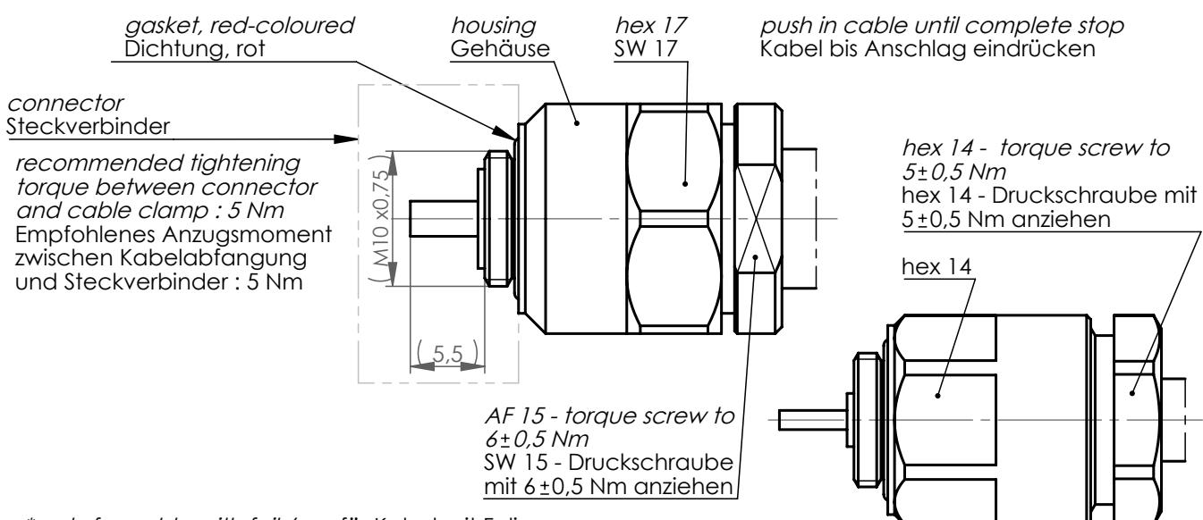
\* only for cable with foil / nur für Kabel mit Folie
